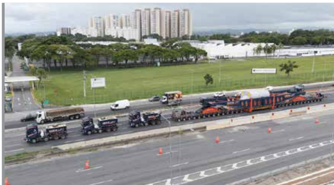
Transporte de estator do compensador síncrono até a Subestação Barra II (Bahia)
