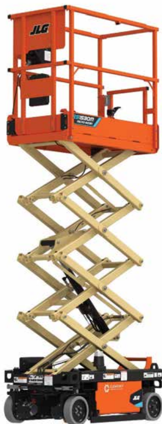
ES1530M ALTURA DE 4,6 M (INTERNOS) E 3 M (EXTERNOS), LARGURA DE 76 CM E CAPACIDADE PARA 227 KG
