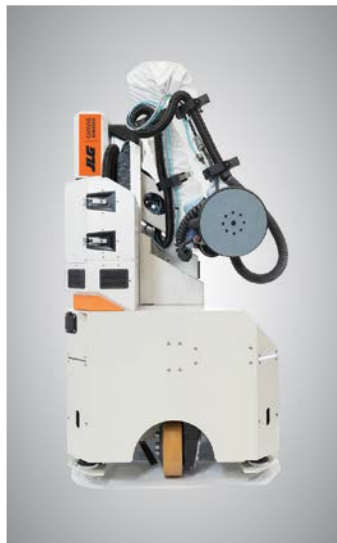
CANVAS 1200CX, ROBÔ AUTÔNOMO COMPACTO VOLTADO AO ACABAMENTO DE DRYWALL
