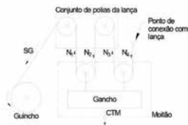
Figura 1. Esquema para cálculo da Carga de Trabalho do Moitão (CTM).
