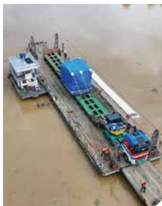
Balsa sobre o Rio Caeté: ponte não estava habilitada para suportar o peso das cargas transportadas
