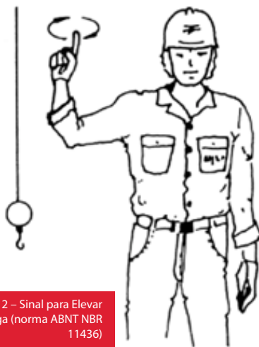
Figura 2 – Sinal para Elevar da Carga (norma ABNT NBR 11436)
