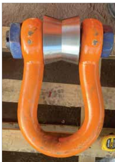
Figura 3. Rolete de aço conectado ao pino da manilha para aumento do diâmetro de dobramento.
