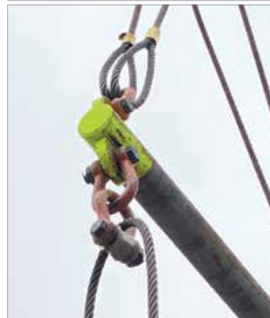
Figura 4. Linga inferior dobrada em um rolete no pino da manilha.
