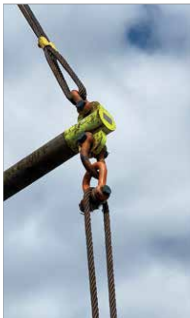
Figura 1. Linga inferior dobrada no rolete conectado ao pino da manilha
