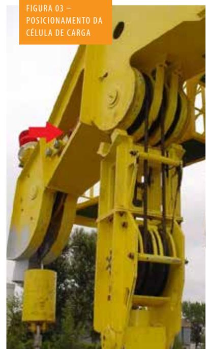
FIGURA 03 – POSICIONAMENTO DA CÉLULA DE CARGA
