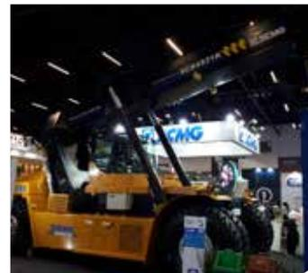
mento lateral ( $\pm 800$  mm) e de rotação ( $-105^{\circ}$ ff $+195^{\circ}$ ), bem como controle de trava por torção. O sistema de lubrificação é automático, assim como o controle antichamas e a autocompensação. A cabine do motorista, equipada com assento ergonômico e ar condicionado, é móvel e sua visibilidade é complementada por câmeras, inclusive na traseira.
