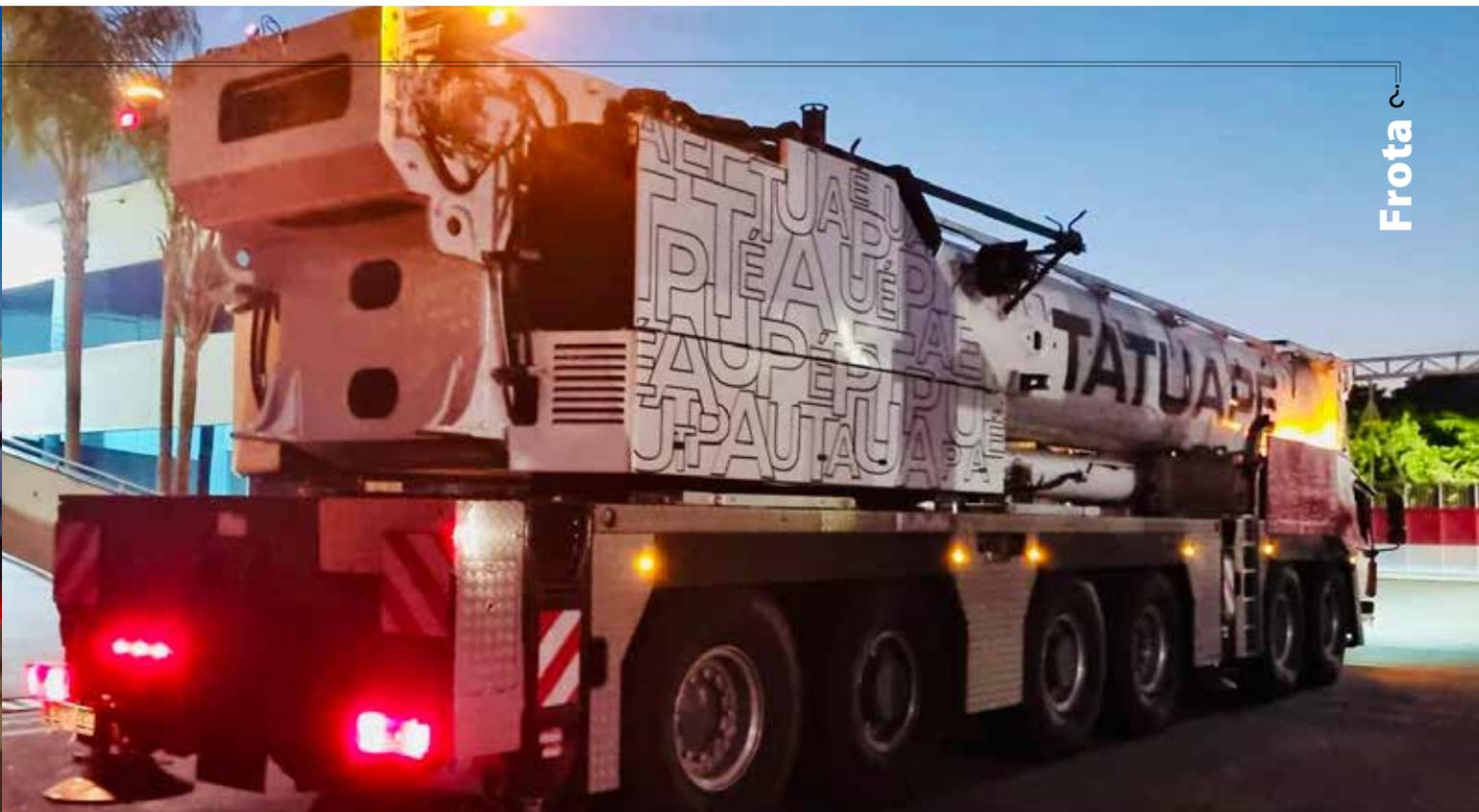
O GMK6450-1 é um guindaste de seis eixos, com uma lança robusta de 60 m, onde pode ser montado um acessório tipo tesoura (MegaWingLift™), que pode ampliar esse alcance até 136 m, sem perder muita capacidade. É uma máquina compacta, com um único motor, sistema de transmissão hidrostático e eixo tipo cardã na parte dianteira. Econômico no deslocamento rodoviário, o GMK6450-1 conta também com modo específico quando parado para configuração ou amarração de cargas.
