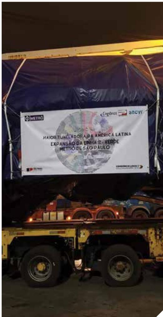
zados dois cavalos mecânicos Mercedes-Benz Actros 8x8, para recebimento da carga no porto, e 11 cavalos mecânicos Volvo, em composições de transporte com quatro pranchas (3 eixos, 4 eixos e lagartichas) e 20 carretas carga seca Randon, além de 44 linhas de eixo Cometto e três veículos de apoio.
