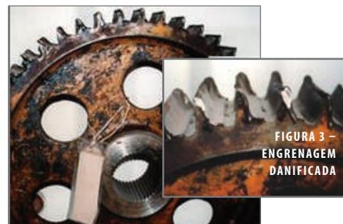
FIGURA 3 – ENGRENAGEM DANIFICADA
