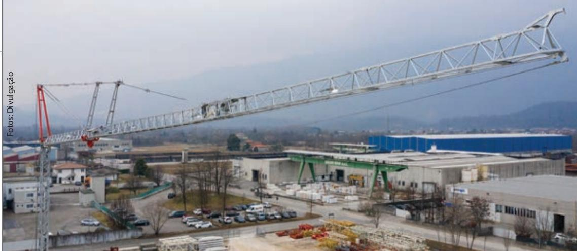
A Terex lançou um novo guindaste para terrenos acidentados (Terex TRT 65) e uma grua auto montante (CSE 40). O TRT 65, com capacidade máxima de elevação de 65 t, conta com lança hidráulica principal de quatro seções com extensão de 43,5 m, e lança treliçada opcional de 8/15 m – permitindo uma altura máxima na ponta de 58,5 m. Com dimensões compactas, o equipamento tem quatro modos de direção, joysticks eletro-proporcionais ergonômicos e personalizáveis e cabine extra larga e inclinável.
