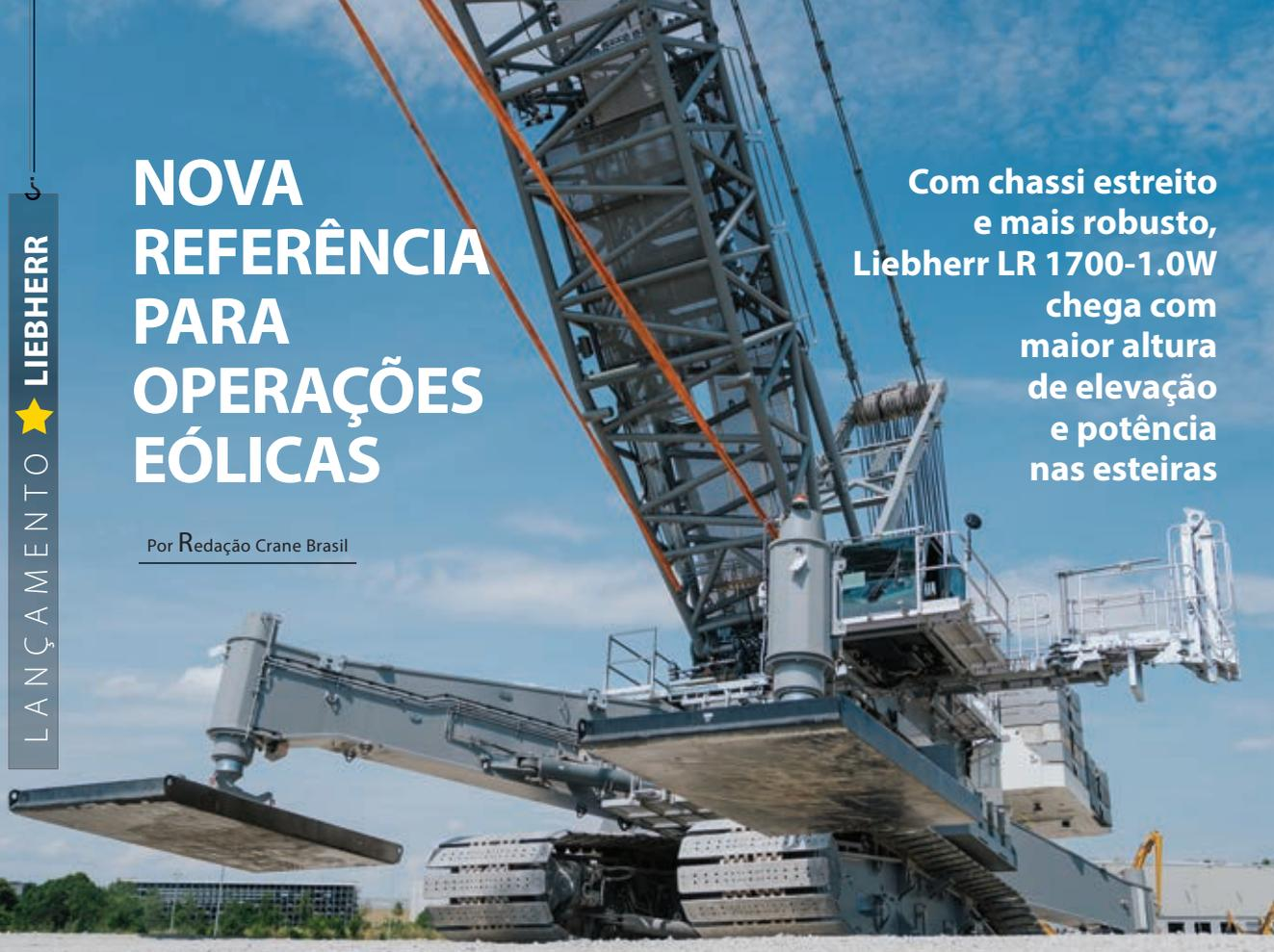
Sucessor do bem-sucedido guindaste sobre esteiras com chassi estreito de 600 t (LR 1600/2-W), o novo Liebherr LR 1700-1.0W (700 t) é mais potente e tem maior altura de elevação. Oferece, portanto, melhores pré-requisitos para a montagem eficiente dos modernos aerogeradores em parques eólicos. Para garantir performance superior de condução e direção, a Liebherr equipou o novo guindaste com componentes utilizados em guindastes de capacidades ainda maiores.
