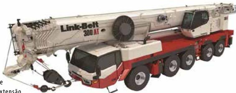
o sistema de controle V-CALC do Link-Belt 300AT agora inclui posicionamento variável das patolas, com configuração totalmente assimétrica e quatro posições de extensão: totalmente retraído, 40% para fora, 70% ou totalmente estendido.
