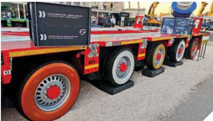
Durante a feira de Bauma 2022, a Goldhofer apresentou uma novidade mundial em equipamentos de transporte de cargas especiais: a Série F. Trata-se de um sistema de combinação de eixo pendular montado em pivô na classe de carga útil pesada, projetado tanto para operações de transporte rodoviário quanto para manuseio de cargas pesadas em áreas não públicas. É um sistema inteligente que combina semi-reboques e módulos para serviços pesados.
