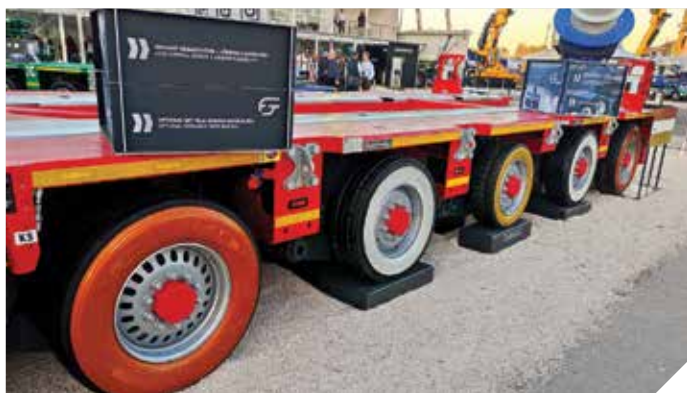
Série FT: Três pneus para diferentes alturas de carga
