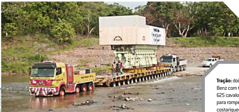
**Tração:** dois Mercedes-Benz com tração 8x6 e 625 cavalos no motor para romper as barreiras costariquenas.
