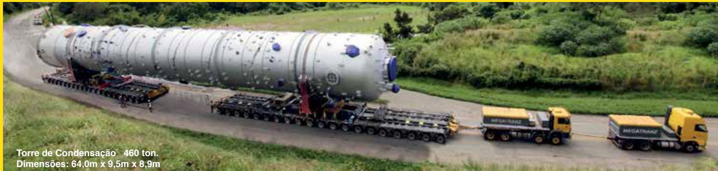
Conjunto Transportador - 40 linhas de eixo (20 + 20 com 3ª fila) Total de 480 pneus
