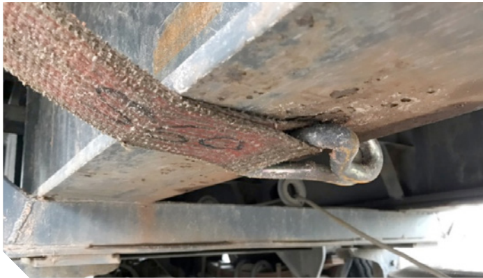
Conexão perpendicular de gancho J no chassi do veículo de transporte
