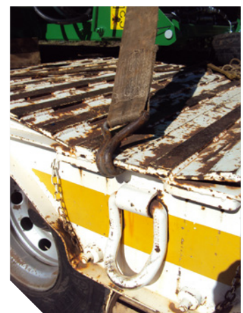
Ganchos J de dimensões insuficientes para conexão nos pontos de ancoragem da prancha rebaixada
