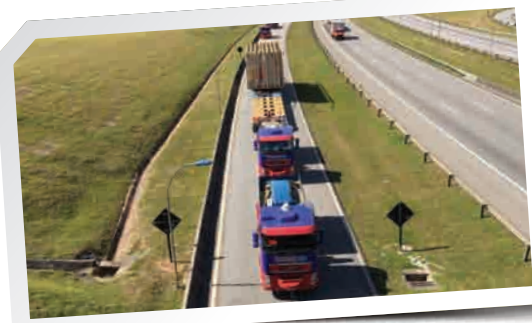
▲ Trafo, com 205 toneladas: a carga mais pesada da história da companhia
