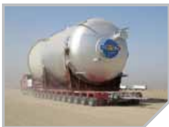
Um conjunto de 12 eixos (duas filas) formado por dois módulos de 6 eixos
