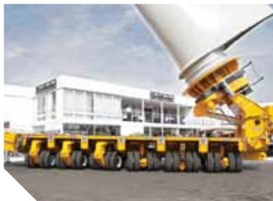
As novidades da **Goldhofer** foram concentradas em sua linha MPA. Uma das mais marcantes, destinada à indústria eólica, foi o reboque autopropelido PST/SL-E 6, com 6 eixos, acoplado ao sistema FTV 300 para o transporte de rotores de turbinas. O dispositivo é ideal para terrenos de difícil acesso, pesa 13,5 t (sem carga) e tem momento de carga de 300 t. Possui ainda acionamento hidrostáti-
