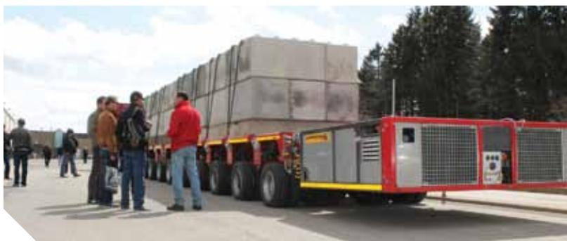
zando sua gama de veículos propelidos, a Faymonville também ampliou a linha SPMC de transportes pesados off-road. Três diferenciais marcam o SPMC: um sistema de acionamento inovador com modernos elementos eletrônicos, a operação amigável e um sistema de diagnóstico exclusivo. A empresa busca aliar uma plataforma
